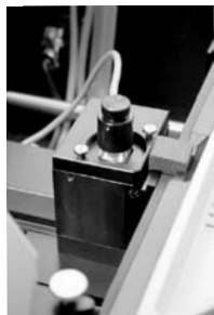
- Ci-dessus (Fig.1) : SPECORD® PLUS avec support de cuvette à thermostatisation par effet Peltier et échangeur thermique externe
